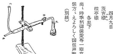
その水暖になる時ハ(口)号管の口より出でざらしむ。此冷氣に由りて(レ)より発勝せる蒸氣凝結するなり。
